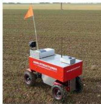
**Drone Agri-Structures couplé à un effaroucheur Agri-Protech**
